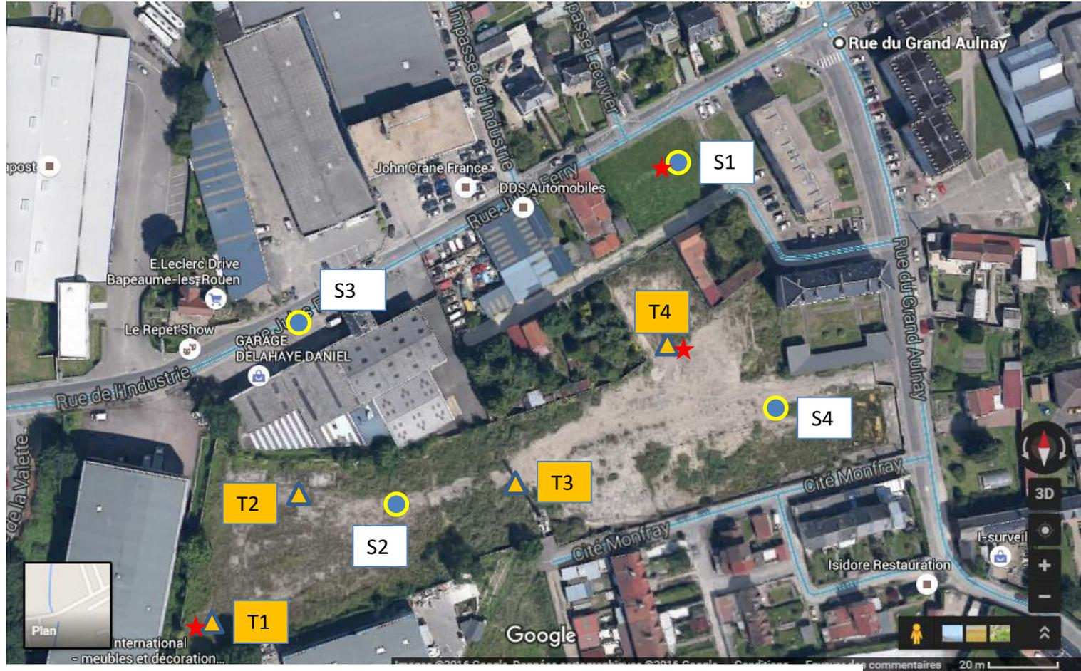
● Sondage pressiométrique à 10 m avec piézomètre (crépine de 1 m jusqu'à la base)
